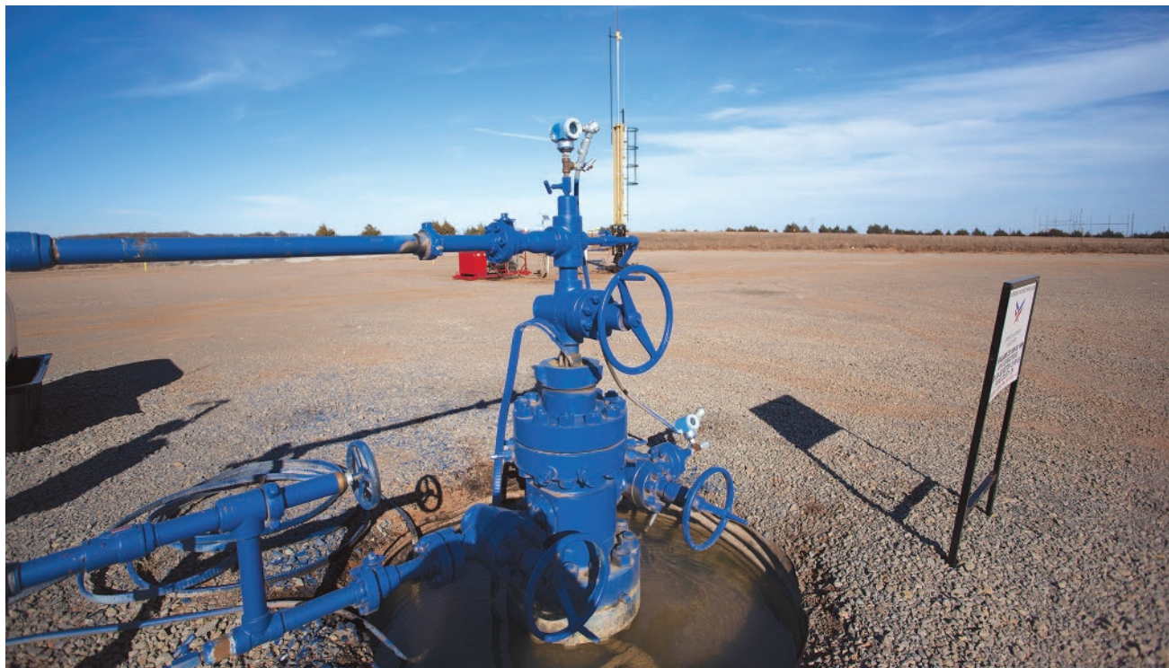
Устье скважины в Койле, штат Оклахома, предназначенной для захоронения отработанных вод. В Оклахоме действуют тысячи таких скважин.
