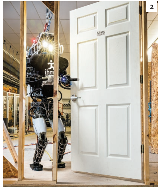
В экспериментальной лаборатории при Институте изучения когнитивных способностей человека и машин, где он был создан, «Бегающий человек» поднимается по лестнице (1) и открывает дверь (2) — обе эти задачи поставлены DRC. Во время соревнований роботом управлял Джон Карфф; здесь он в лаборатории за пультом управления (3).
