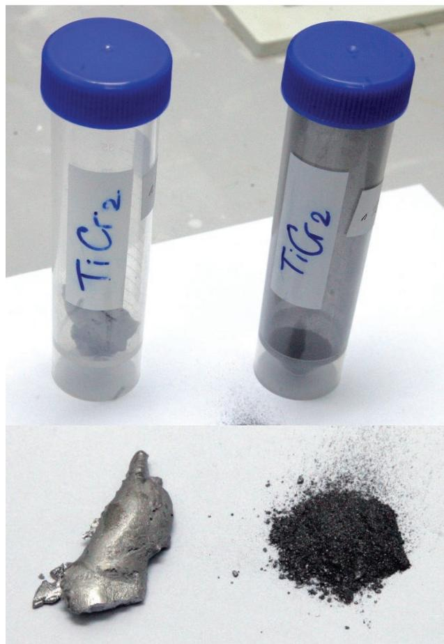
Один из перспективных видов твердотельного накопителя до (слева) и после нескольких циклов «перезарядки» водородом
