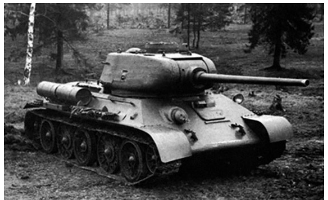
Одной из первых задач института была разработка брони и надежных монолитных литых башен для Т-34. Михаил Ильич Кошкин был первым главным конструктором танка.
