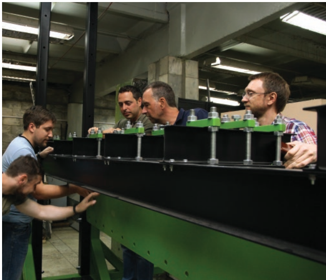
На производственной базе ТПУ представителям CERN продемонстрировали созданный в университете стенд для испытания элементов системы перемещения трекового детектора эксперимента LHCb
