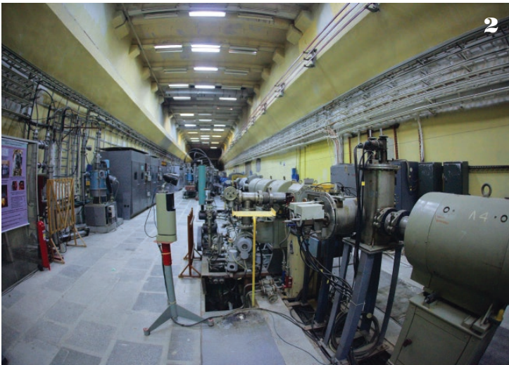
1. Здание вычислительного центра ИФВЭ НИЦ «Курчатовский институт» 2. Линейный ускоритель протонов УРАЛ-30
