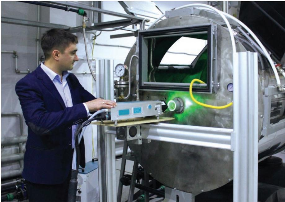
Кандидат технических наук Д.В. Гвоздяков демонстрирует работу камеры распыла водоугольного топлива
