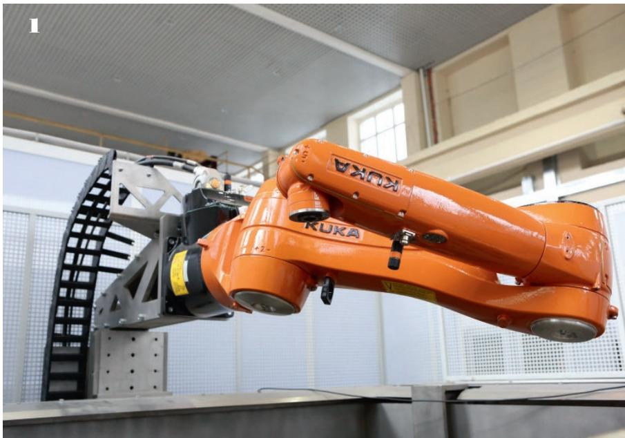
1, 2. Роботизированная система ультразвуковой томографии
