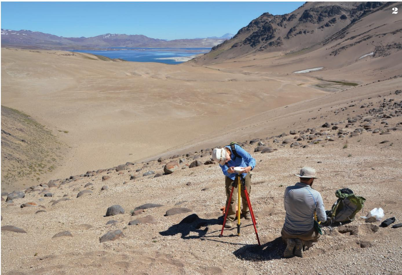
**Черты вулканического ландшафта** Лагуна-дель-Мауле видны на космическом снимке (1): растительность (красный) и покрытые снегом вершины гор (белый). Геологи устанавливают датчики около озера, чтобы определить поднятие земли (2).
