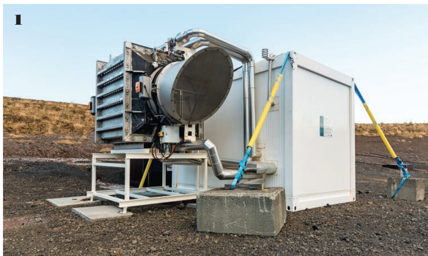
Установка компании Climeworks всасывает \text{CO}_2 из атмосферы (1). Нагреватель внутри купола (2) закачивает газ более чем на 700 м под землю, где он вступает в реакцию с базальтовыми коренными породами, при этом образуются карбонаты, видимые как белые потоки на образце керна, вырезанного из толщи базальта (3).
