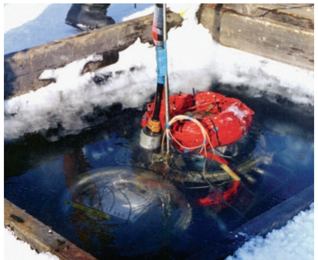
Монтаж гирлянды оптических модулей первого в мире глубоководного нейтринного телескопа NT-200 на Байкале
