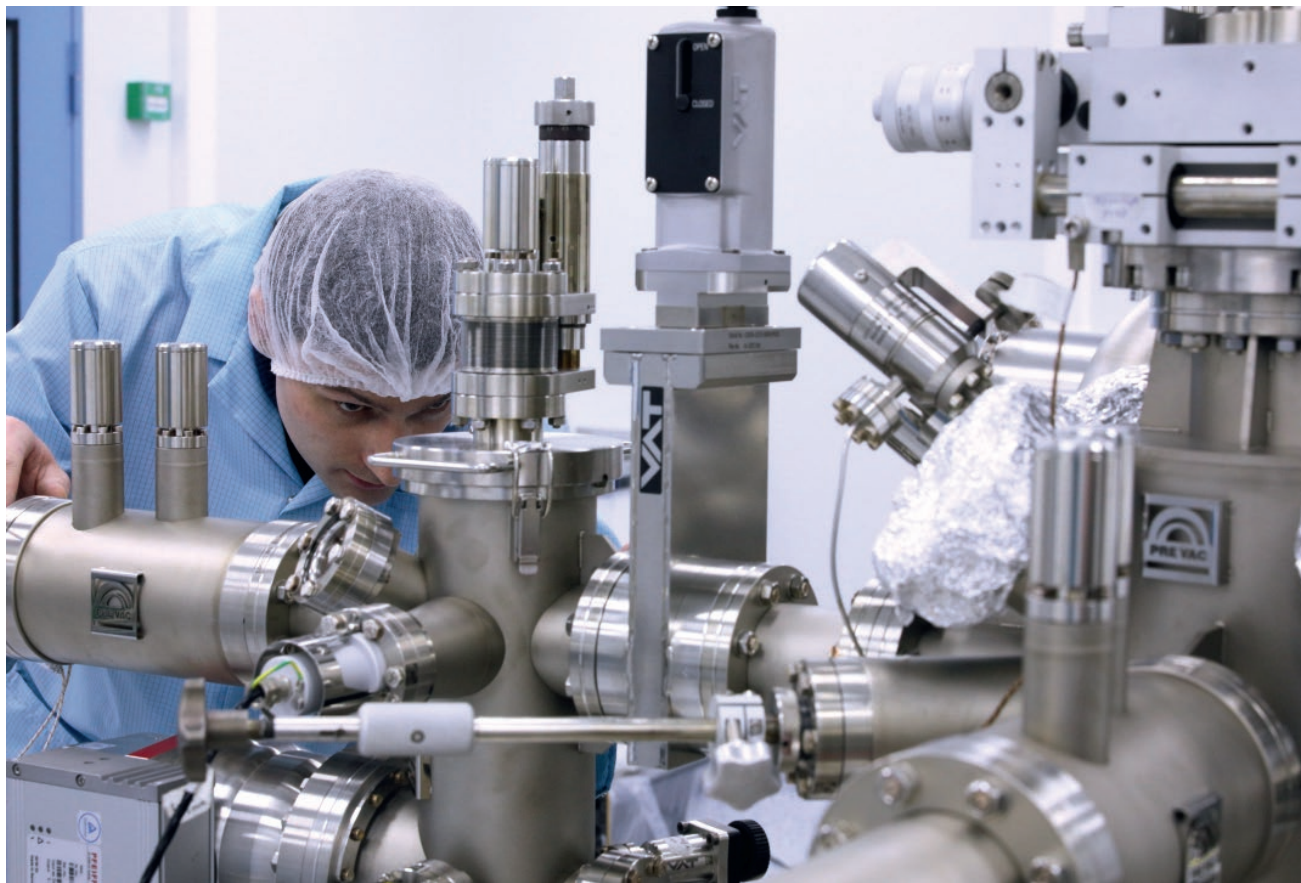
Младший научный сотрудник Центра высокотемпературной сверхпроводимости П.И. Безотосный загружает образцы в высоковакуумную установку для измерений фотоэмиссии с угловым разрешением
