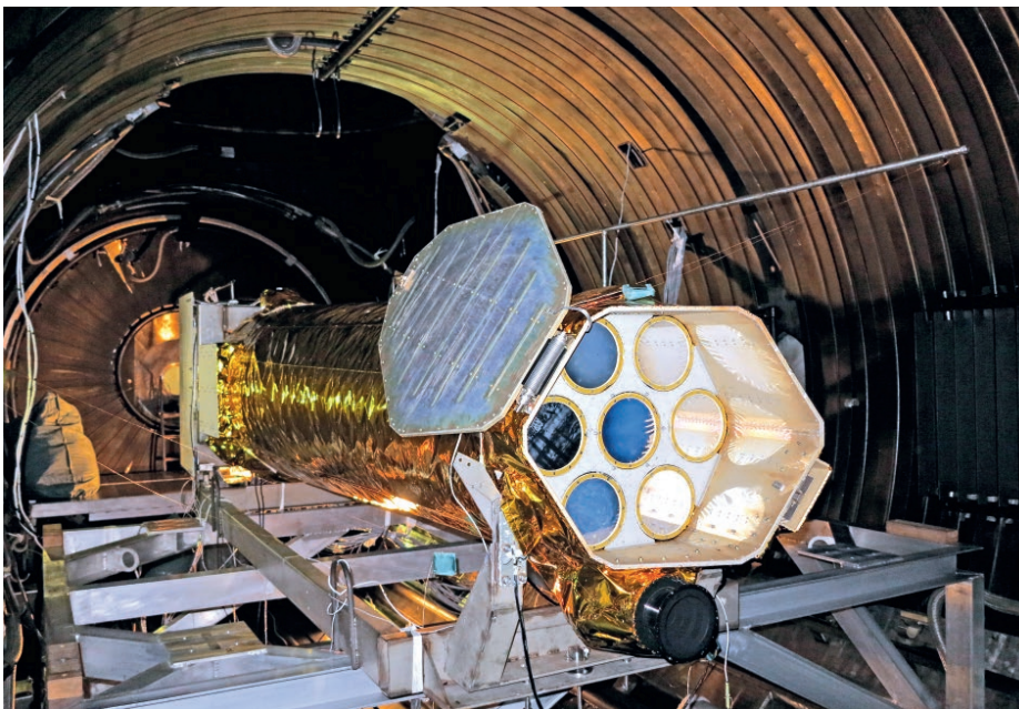
Телескоп ART-XC на испытаниях в РКЦ «Прогресс» (Самара), май-июнь 2016 г. Контрольно-доводочный образец телескопа в термовакуумной камере, крышка откинута. © «Роскосмос»/DLR/СПГ/ИКИ.
