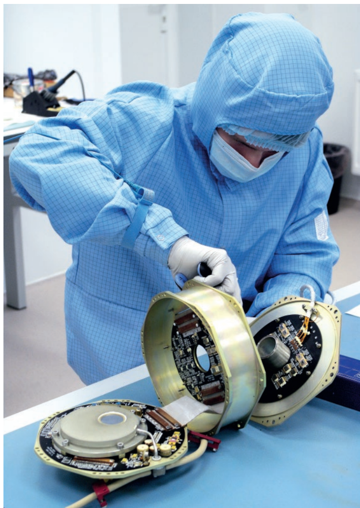
Сборка детекторного модуля для телескопа АРТ-ХС. © «Роскосмос»/DLR/СРГ/ИКИ.
