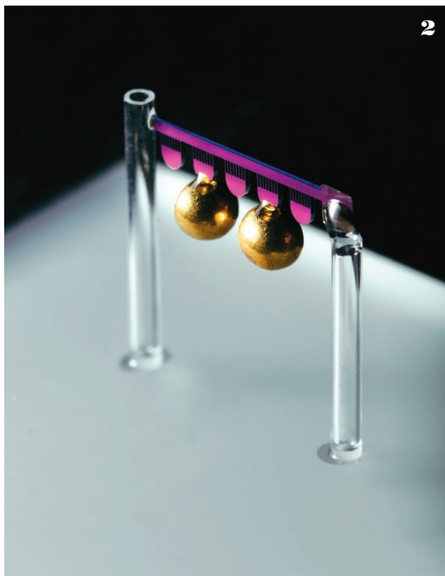
Сверхпроводящий контур (1) помогает эксперименту по левитации. Исследователи пытаются измерить гравитационные поля золотых сфер миллиметровой толщины (2), чтобы наблюдать гравитацию ближе к квантовой области.
