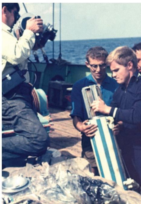
Зондирующий биолюминометр «Ромашка» с батометрами для прицельного взятия проб воды по измерениям биолюминесценции (слева). Глубоководный автономный биолюминометр покоится на дне Идзу-Бонинской впадины в Тихом океане (справа).
