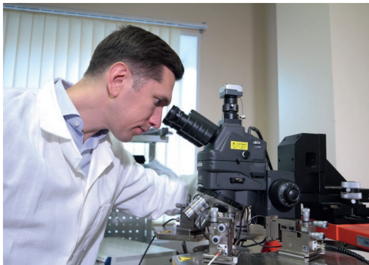
В.А. Демин проводит визуальный анализ качества нейроморфного вычислительного устройства перед электрофизическими измерениями на зондовой станции
