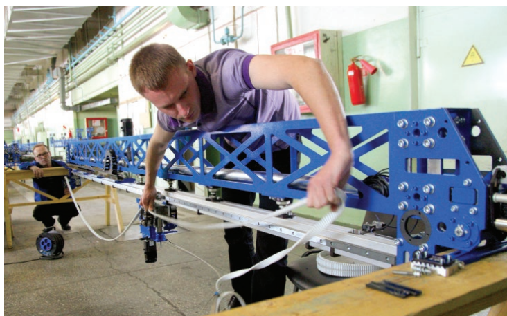
Монтаж элементов активной системы обезвешивания для АО «ИСС им. М.Ф. Решетнева». На переднем плане — ведущий конструктор И.А. Накрохин.
