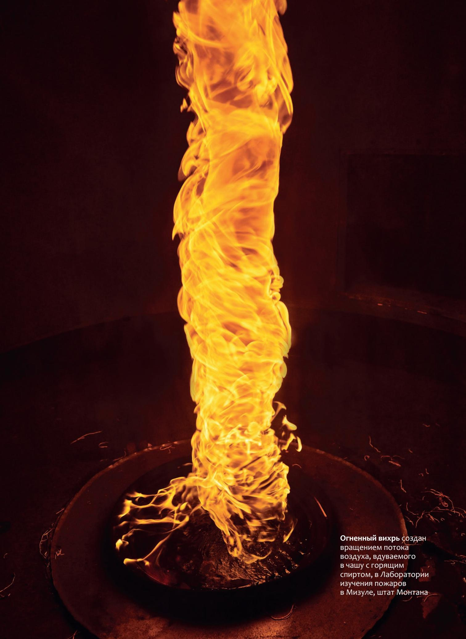
**Огненный вихрь** создан вращением потока воздуха, вдуваемого в чашу с горящим спиртом, в Лаборатории изучения пожаров в Мизуле, штат Монтана
