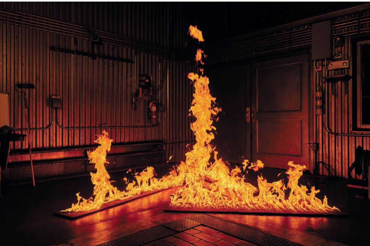
*Горящие доски уложены в виде треугольника, позволяя воздуху кружиться в центральной части, где другое пламя закручивает его в вихрь. Лесной или городской пожары определенных очертаний могут таким образом породить огненные смерчи.*
