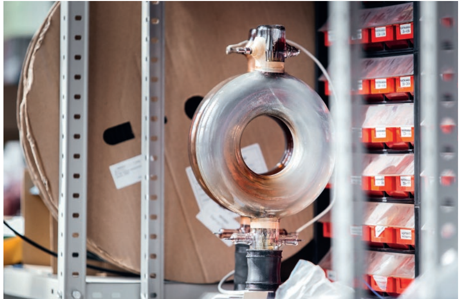
Сердце бетатрона — вакуумная ускорительная камера из молибденового стекла
