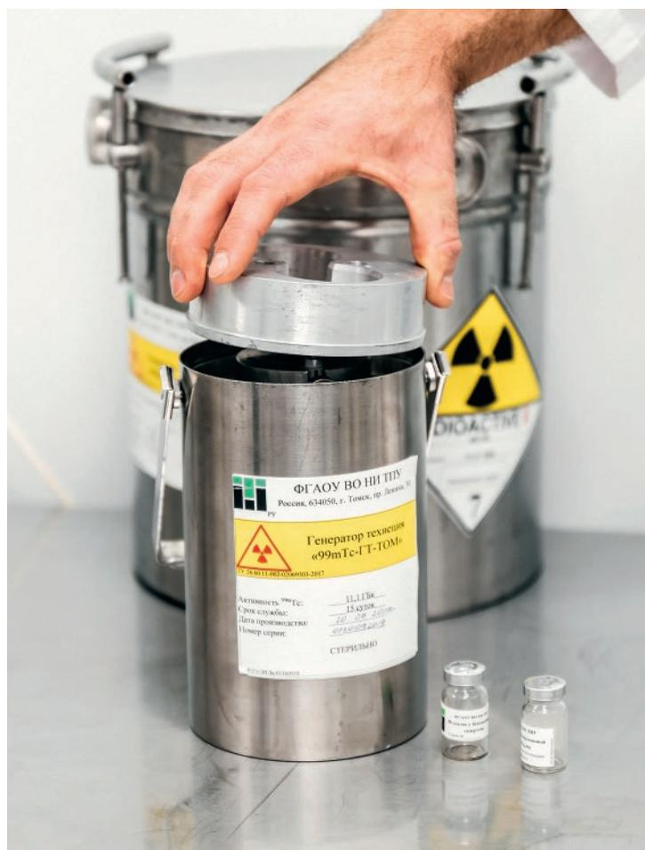
Генератор изотопа технеция-99
