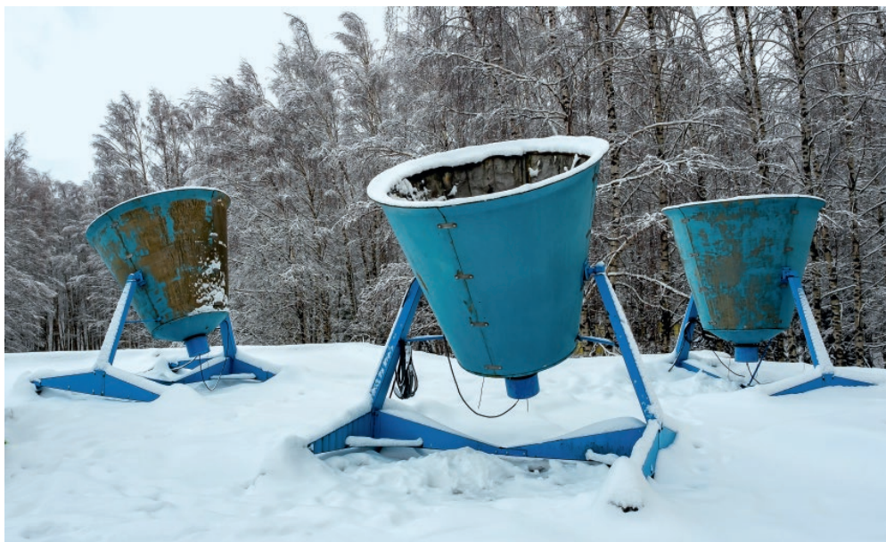
Акустический доплеровский локатор (содар) — регистрация вертикальных профилей скорости ветра
