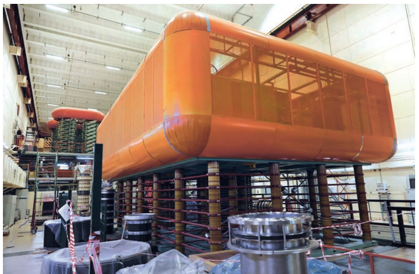
Прототип высоковольтного инжектора , предназначенного для нагрева плазмы в крупных термоядерных установках
