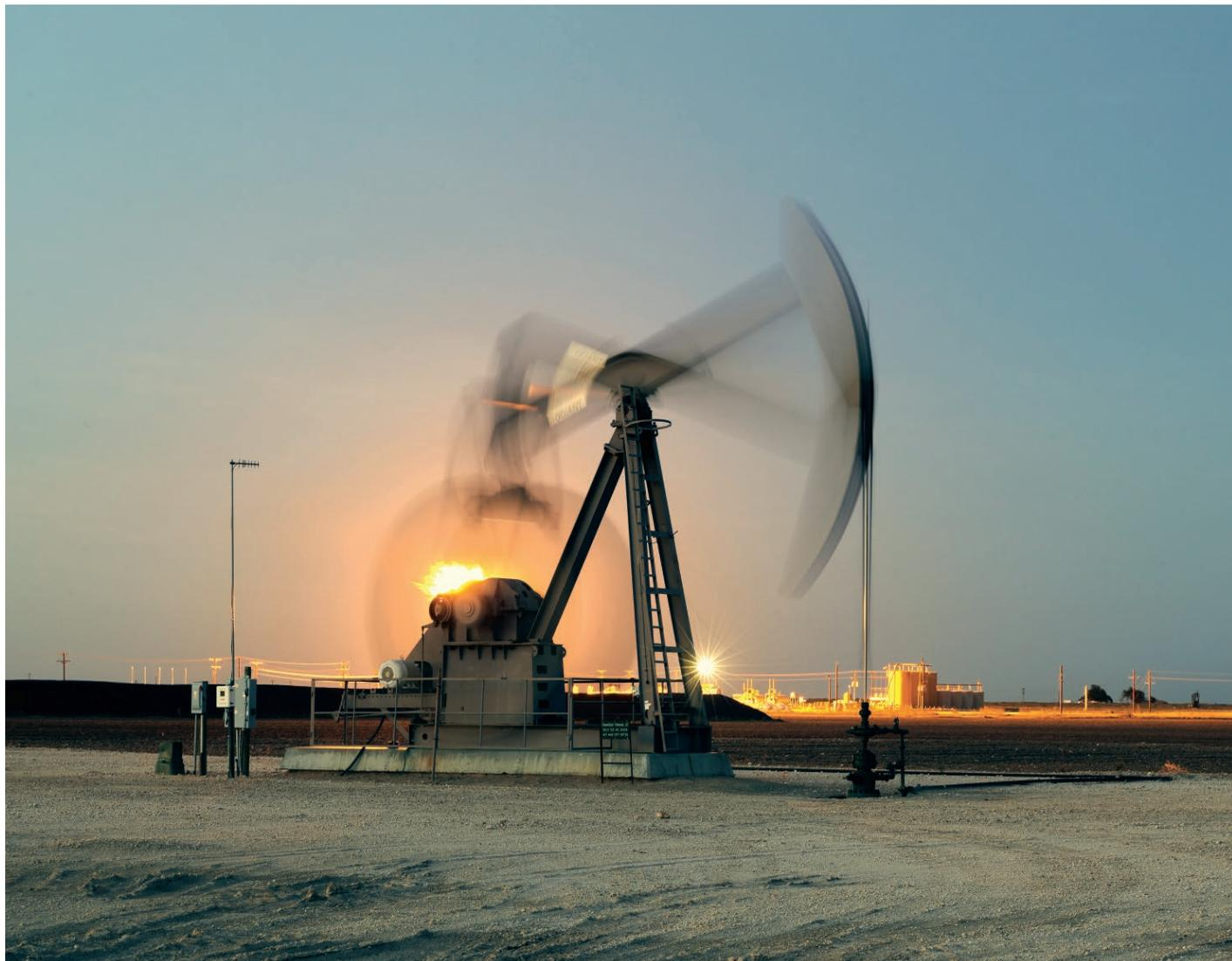
**Нефтекачалки**, приводимые в действие электродвигателем или двигателем внутреннего сгорания, обычно делают кивки вверх и вниз около 20 раз в минуту, вынимая от одного (3,79 л) до десяти (38 л) галлонов жидкости за каждый ход
