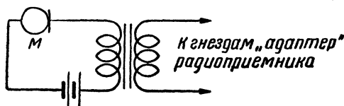
Рис. 33 Схема включения угольного микрофона
