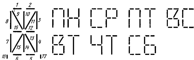
Рис. 1. Формирование букв с помощью индикаторов ИВ-4: а — сегменты; б — сочетания сегментов для формирования букв
