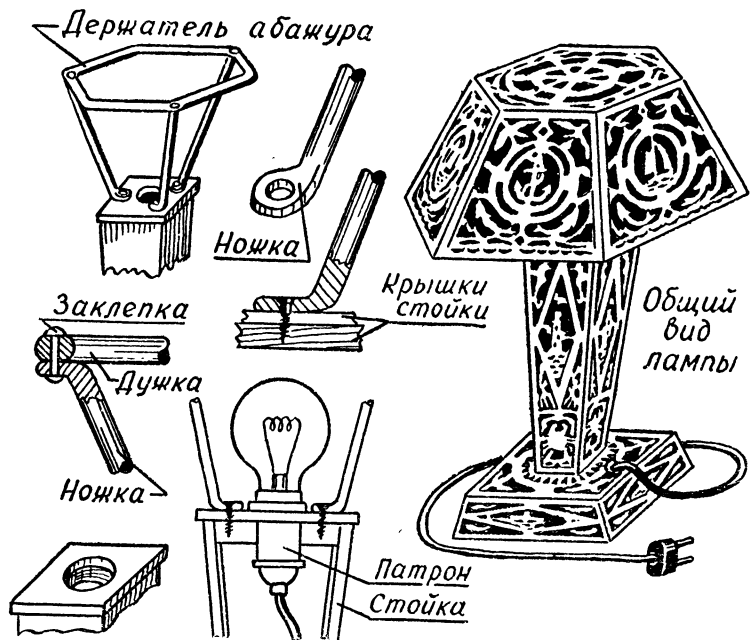
Рис. 21. Настольная лампа. Схема устройства и общий вид.
