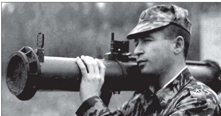
Этот одноразовый РПГ-27 «Таволга» имеет тандемную боевую часть и пробивает броню любого танка на ближней дистанции
