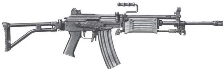
Автомат «Галил» — отличается от АК складывающимся прикладом, более длинным стволом, двусторонним предохранителем и ручкой заряжания, загнутой вверх
