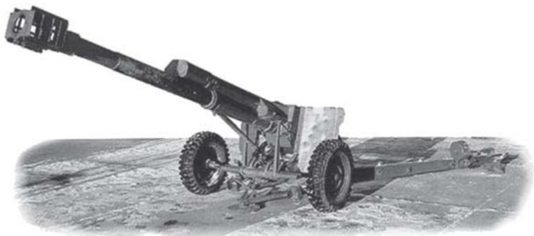
Буксируемое орудие НОНА-К. Принято на вооружение в 1986 г. Может стрелять оперенными противотанковыми снарядами типа «Китолов»
