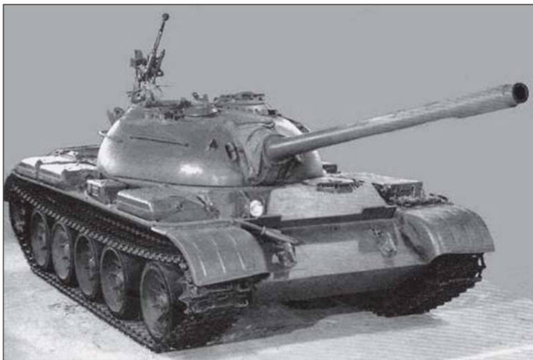
Т-54 — эти танки имели уже систему стабилизации пушки «Горизонт» и эжекционное устройство для продувки ствола
