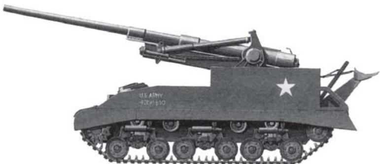
М40 «Длинный Том» — мощная 155-мм пушка на шасси танка М4 «Шерман», в Корее проявило себя как замечательное оружие
