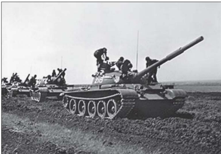
«По коням!.. Нас ждет Забайкалье». Система стабилизации гладкоствольной 115-мм пушки «Метеор» и приборы ночного видения позволяли Т-62 вести эффективный огонь с ходу и с места, днем и ночью
