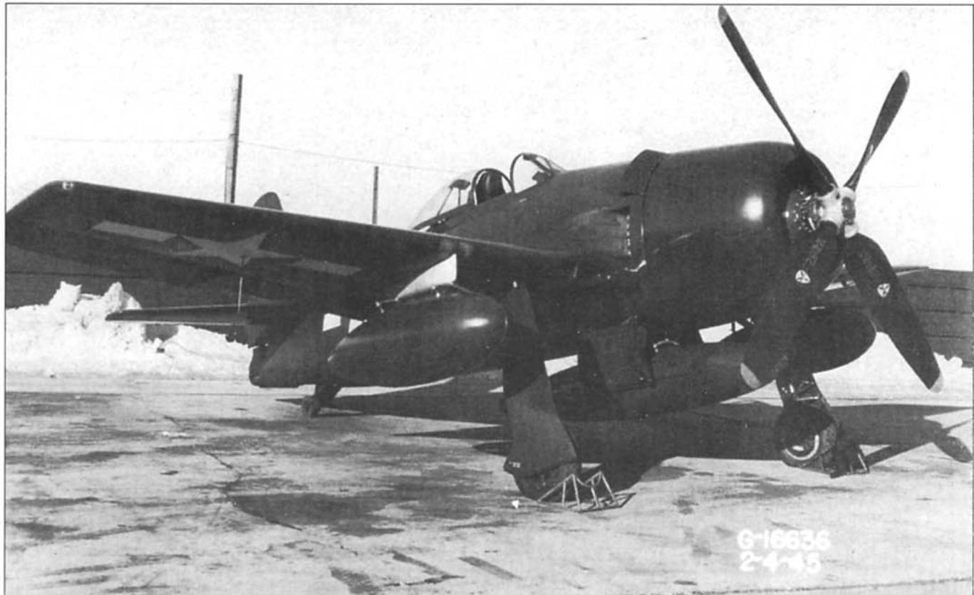
F8F-1 (BuNo 90438) в максимальной конфигурации с двумя подвесными баками по 4100 галлонов и одним 5150-галлонным баком под фюзеляжем. В такой конфигурации дальность полета самолета составляла 3540 км.
