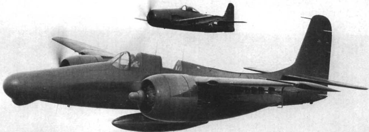
*Два ночных истребителя фирмы «Грумман» - F8F-1N «Биркэт» и F7F-3N «Тайгеркэт». F7F-3N был лучшим ночных истребителем из-за большей дальности полета, лучшего радара и самое главное за счет второго члена экипажа. КМП очень интенсивно использовало эти самолеты в Корее, пока они не были заменены на F3D «Скайнайт».*
