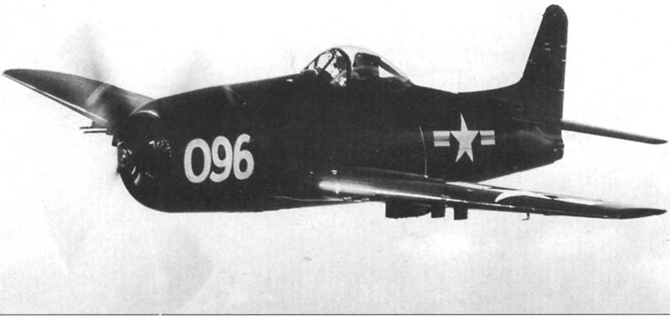
*F8F-1B во время перегоночного перелета, 1947 год. Отличие этой модификации в наличии четырех 20-мм пушек. Стволы пушек на этом истребителе обмотаны бумагой.*
