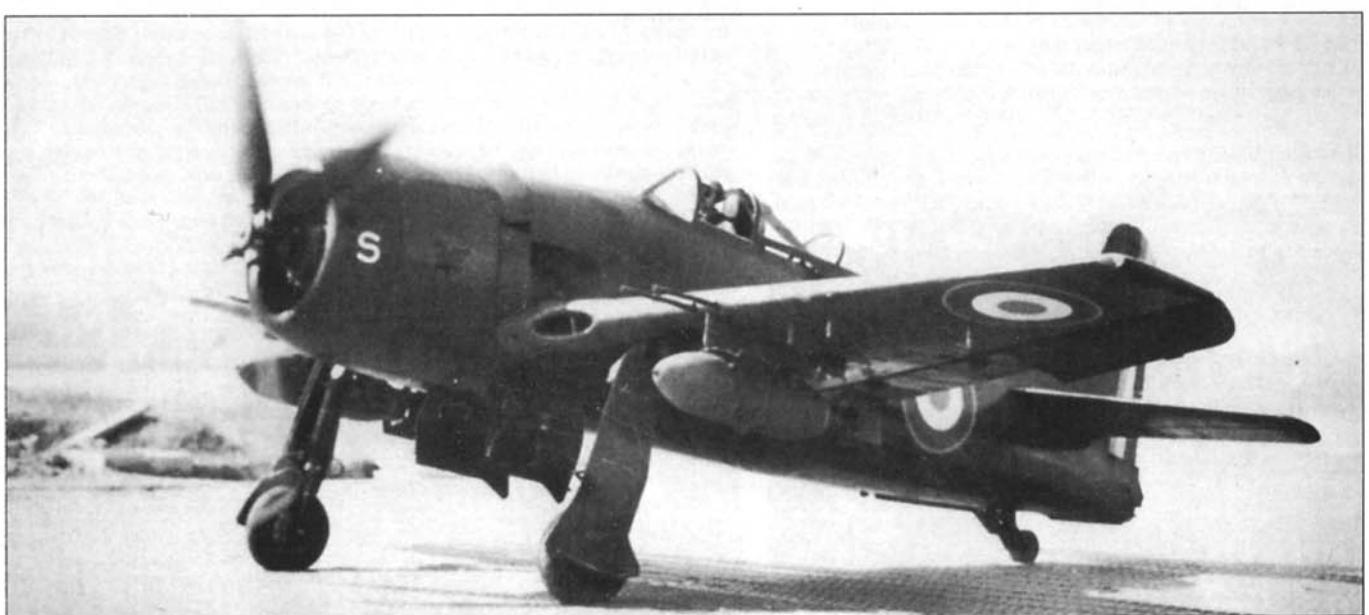
«Биркэт» из состава GC I/21 с двумя подвешенными 227-кг бомбами, полевая площадка где-то в Индокитае, 1952 год. Площадка представляет собой несколько десятков уложенных металлических плит. В ходе боевых действий выяснилось, что довольно тяжелые истребители разбивали эти плиты.
