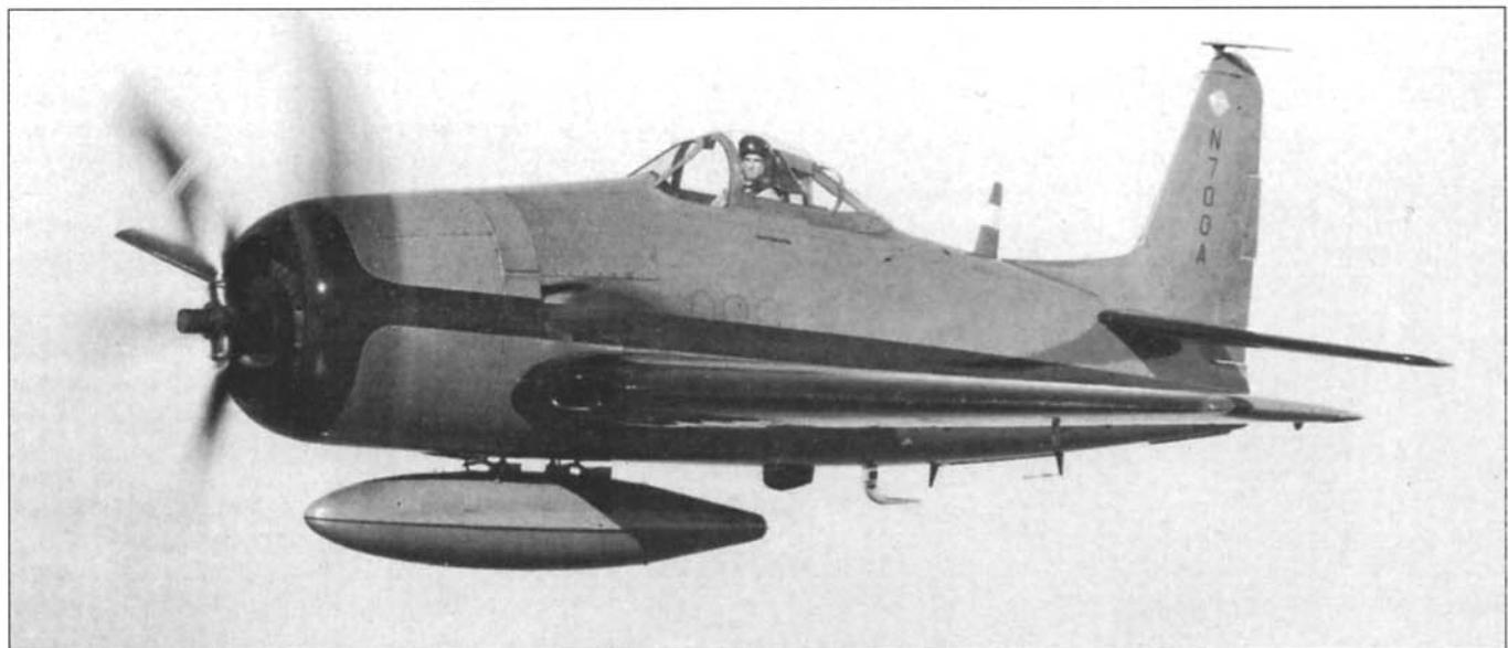
Самолет с собственным именем «Red Ship» был построен фирмой «Грумман» из нескольких «Биркэтов». Поэтому на фюзеляже F8F-2 установлен двигатель R-2800-34W от F8F-1. Подвешенный подвесной бак использовался обычно для перевозки запчастей и инструментов.
