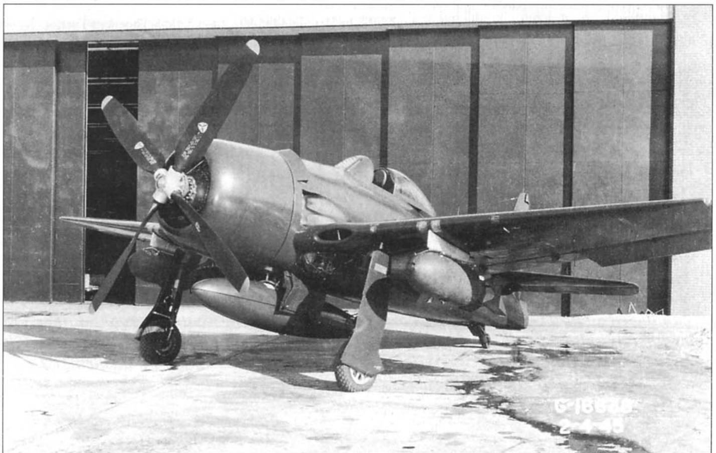
F8F-1 (BuNo 90438) был оставлен на фирме и использовался для испытаний в феврале 1945 года. Преимущественно на самолете проводили эксперименты с вооружением - на фото на самолет подвешен подвесной топливный бак и две бомбы по 272-кг.
