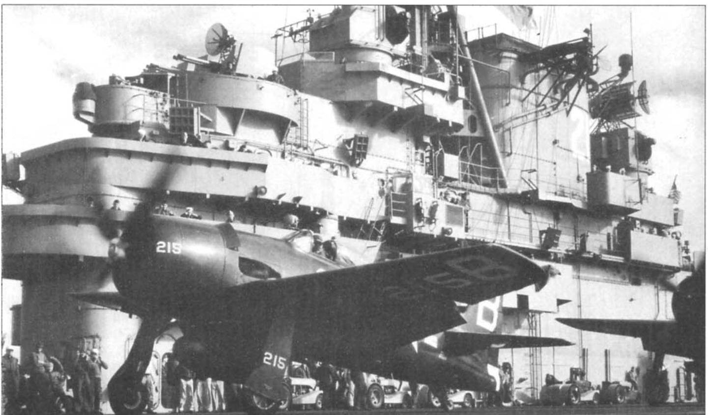
Приготавлившаяся к взлету F8F-1 из состава VF-192, авианосец USS BOXER (CV-21), 1948 год. Используя встречный ветер «Биркэты» очень часто взлетали с более коротких дистанций, чем при использовании катапультных полос авианосца.
