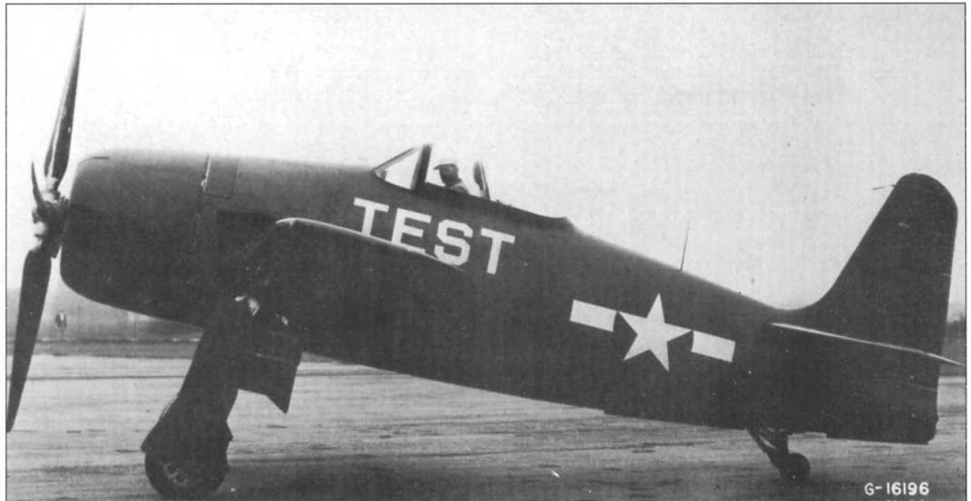
Первый из двух прототипов XF8F-1 отличался от предсерийных и серийных «Биркэтов» высотой киля.
