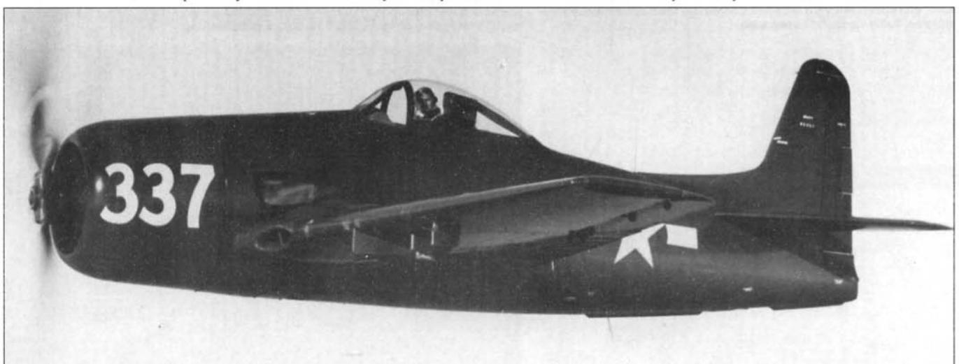
*F8F-1 одной из последних серий в полете, 1946 год. Большой тактический номер нанесен белым на носу на время перегонки. Характерные для поздних серий направляющие для НАР Mk.9 под крылом и заголовник кресла пилота.*
