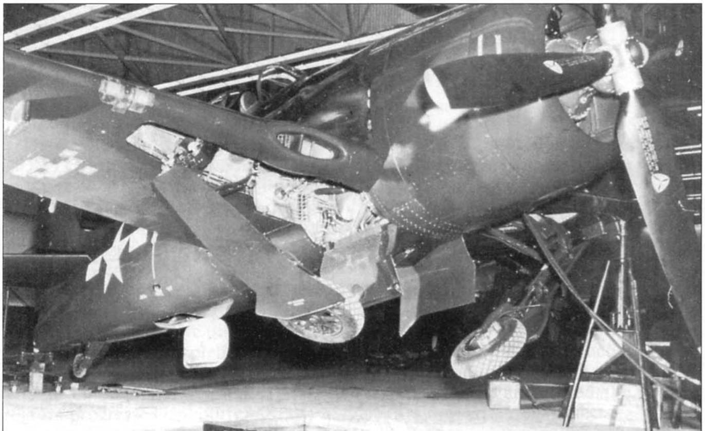
*F8F-1 на испытаниях складывающегося шасси на заводе «Грумман». Система складывания шасси на «Биркэт» была одной из самых сложных на американском флоте.*
