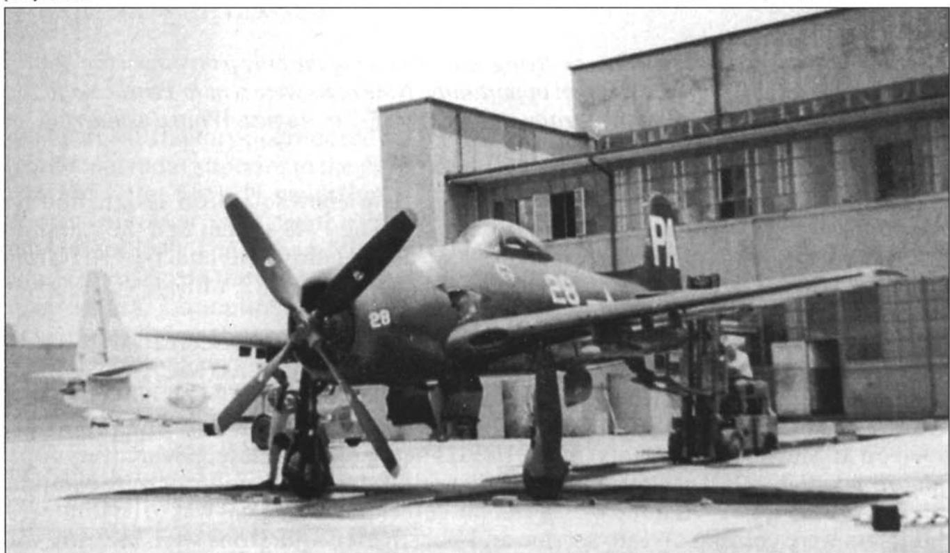
*F8F-1N из состава VCN-1 на очередных испытаниях на вес и балансировку на NAS «Barbers Point», май 1947 года. Для испытаний радар был демонтирован.*
