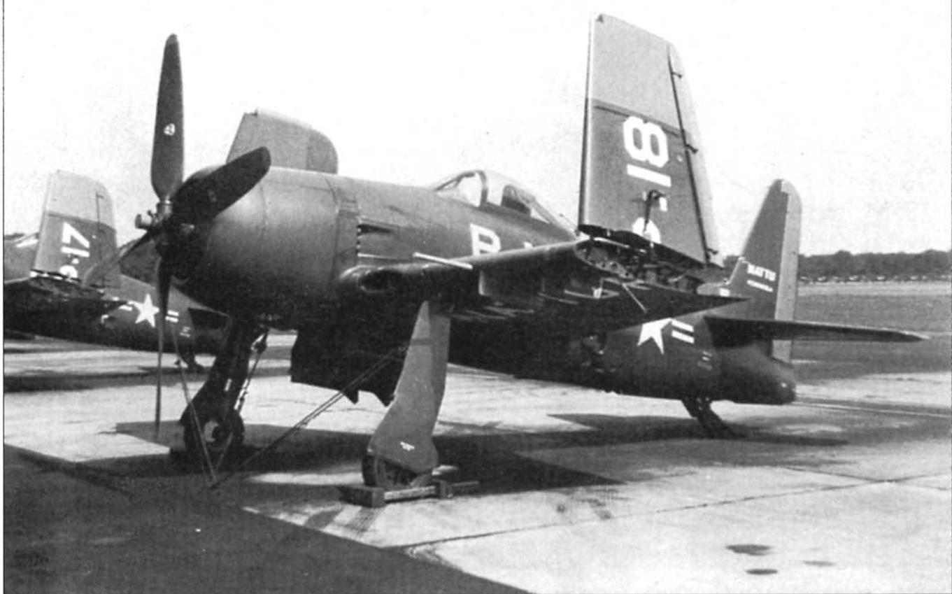
F8F-2P на площадке NAS Pensacola, 1949 год. Отличить самолеты этой модификации можно по единственной 20-мм пушке в крыле.
