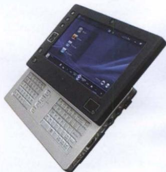
Полноценный компьютер (одновременно GPS-навигатор) весом всего 720 граммов — мечта любого путешественника. Испанский вариант, именуемый АНТЕС Tiny X60GT, — разработка фирмы АНТЕС. Аппарат оснащен дисплеем с диагональю 6,5 дюйма и удобной QWERTY-клавиатурой. Тактовая частота процессора — 1,2 ГГц. Компьютер обладает 768-мегабайтной оперативной памятью и имеет жесткий диск объемом 30 ГБ, программное обеспечение — Windows XP. Беспроводные коммуникации — Wi-Fi и bluetooth.
