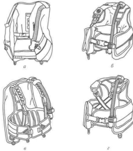
Рис. 6.9. Варианты компенсаторов плавучести:
