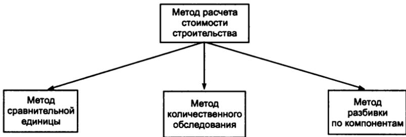
Рис. 9. Классификация методов расчета стоимости строительства
