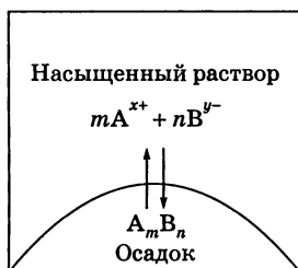
Рис. 11.1. Равновесие в системе «осадок — насыщенный раствор» для сильного электролита
