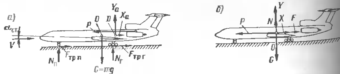
Рис. 9.2. Схема сил, действующих на самолет при движении по ВПП: а — реальная; б — приведенная к центру масс сбалансированного самолета
