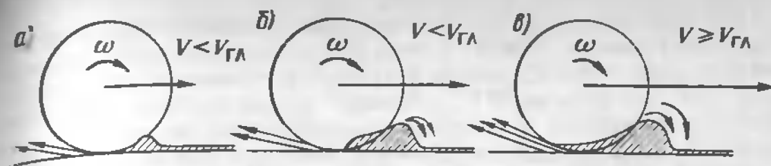
Рис. 13.4. Схема взаимодействия пневматика с ВПП, покрытой осадками при различных скоростях движения
