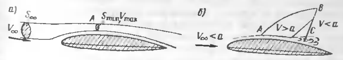
Рис. 2.25. Деформация струйки (а) и границы местной сверхзвуковой зоны (б) при обтекании профиля крыла околозвуковым потоком
