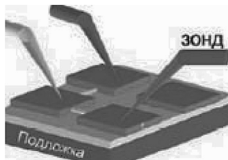
Рис. 11.22. Микрофотография подложки с исследованными нановолокнами; вставка: схема электрических измерений нановолокон с помощью прижимных микрозондов
