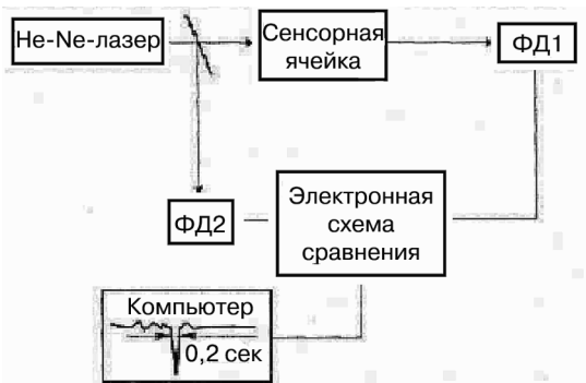
Рис. 9.7. Схема измерительной установки, использованной для исследования интегрально-оптического химического датчика, изготовленного легированием \text{PbO}_2 в стеклянную подложку
