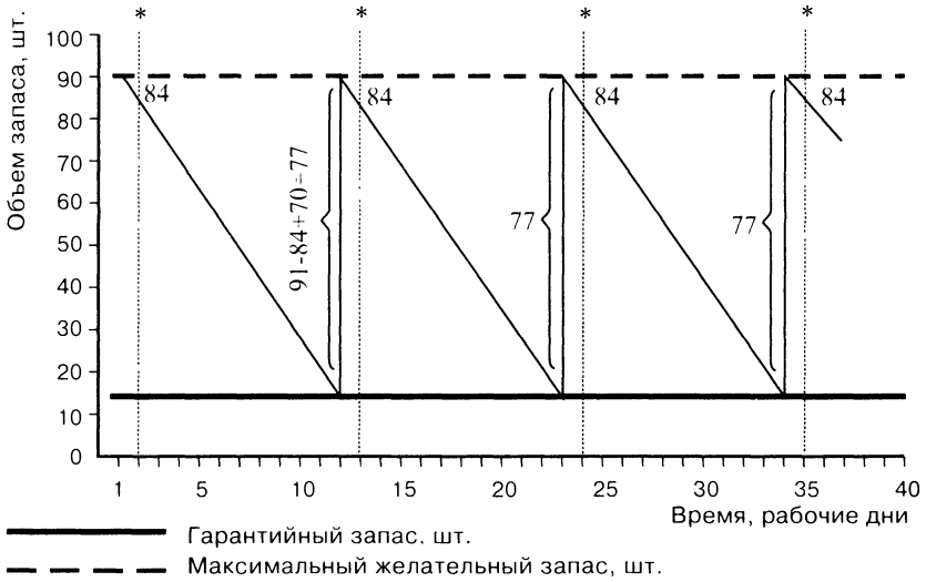
Рис. 5.8. Графическая модель работы системы управления запасами с фиксированным интервалом времени между заказами при отсутствии сбоев в поставках
