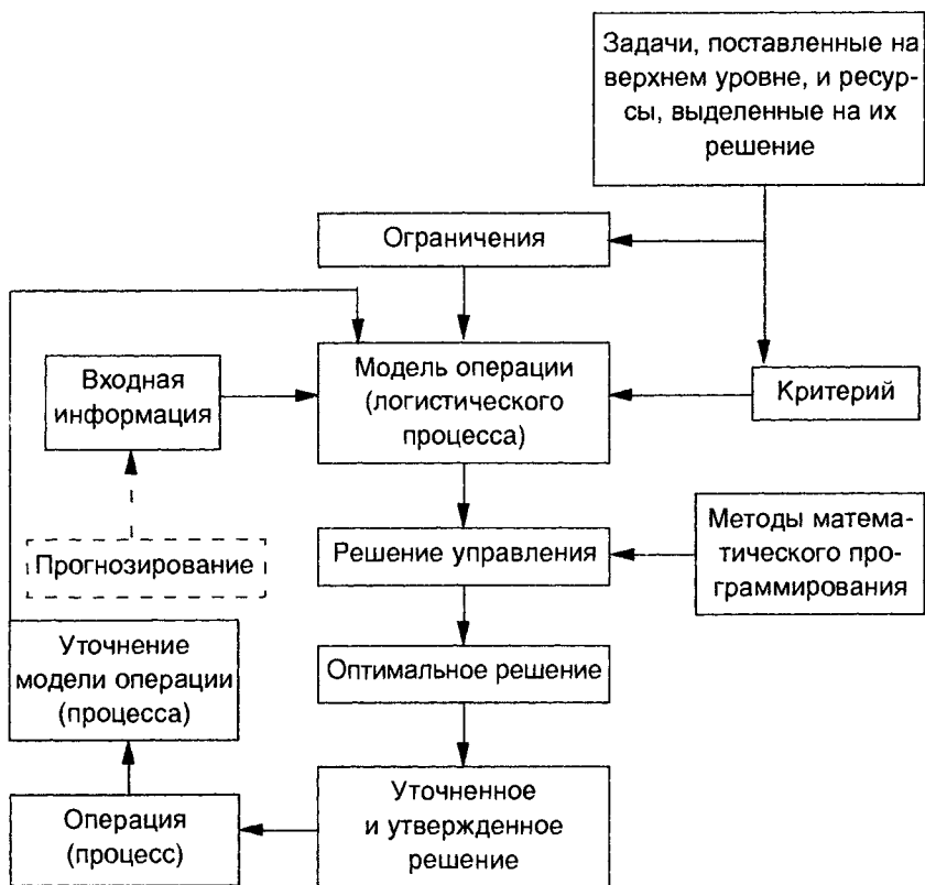
Рис. 8.3. Принципиальная схема операционного метода
