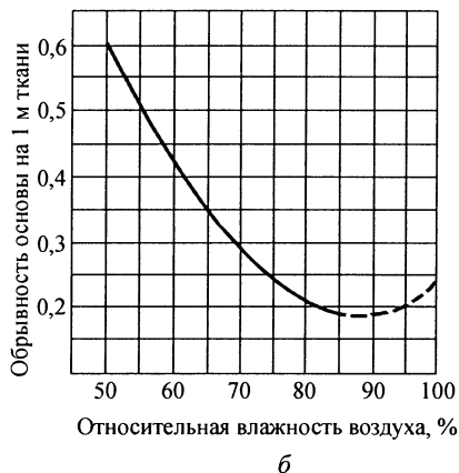
Рис. 1.3. Зависимость обрывности нитей основы от температуры (а) и относительной влажности воздуха (б)
