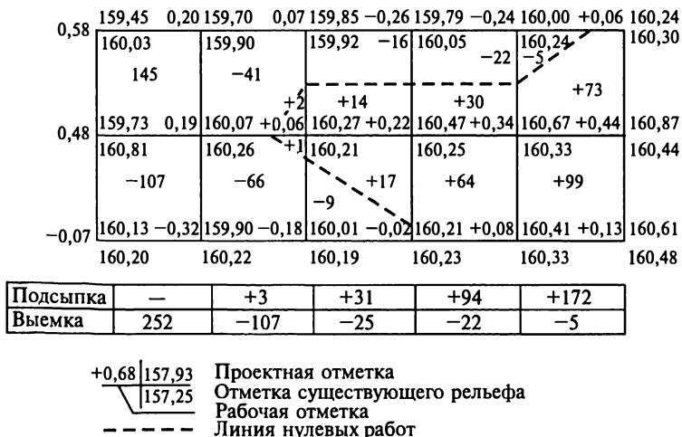
Рис. 18.6. План земляных масс с таблицей баланса
