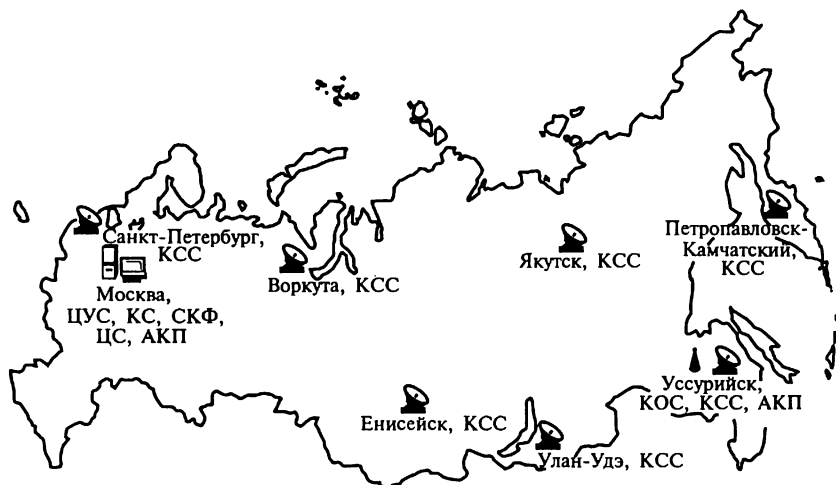
Рис. 14.6. Размещение станций контроля и управления системы ГЛОНАСС: ЦУС — центр управления системой ГЛОНАСС; ЦС — центральный синхронизатор; КС — контрольная станция; СКФ — система контроля фаз; КОС — квантово-оптическая станция; АКП — аппаратура контроля параметров; КСС — контрольная станция слежения
