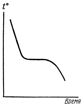
Рис. 371. Кривая охлаждения сплава Вуда.
