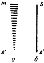
Рис. 182. Изображение отрезка прямой элементарными астигматическими пучками лучей
