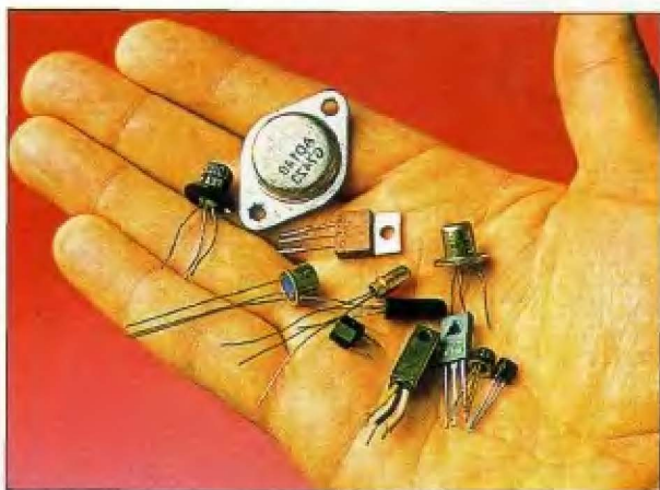
Каждый из этих предметов – корпус, в котором находится всего один транзистор!
