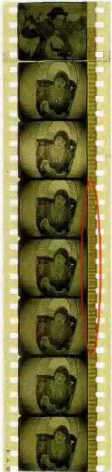
Так выглядела звуковая дорожка на киноплёнке (система «фонофильм» Ли де Фореста)
