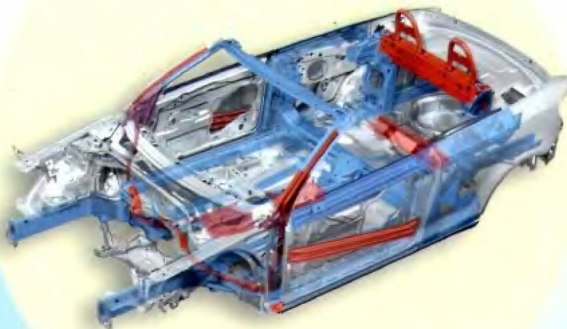
Красным цветом выделены элементы кузова, отвечающие за безопасность
