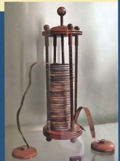
Вверху: схема соединения вольтовых столбов для получения нужного напряжения. Справа: подлинный вольтов столб в Политехническом музее.
