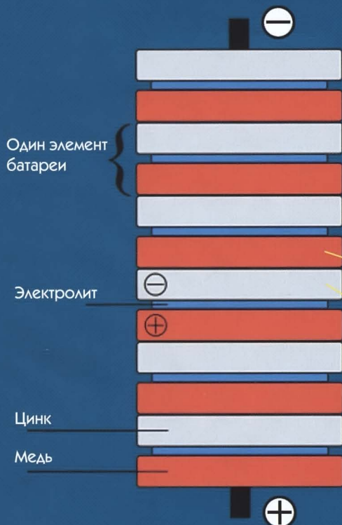
Схема и внешний вид конструктивных элементов современной электрохимической батареи.
