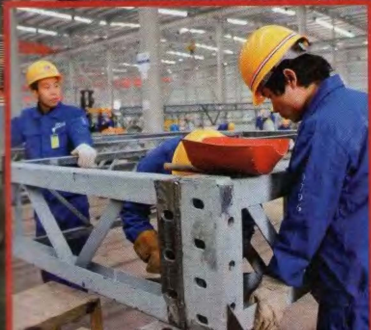
Рабочие собирают блок на заводе. Соединенный с другими, он составит перекрытие одного из этажей.
