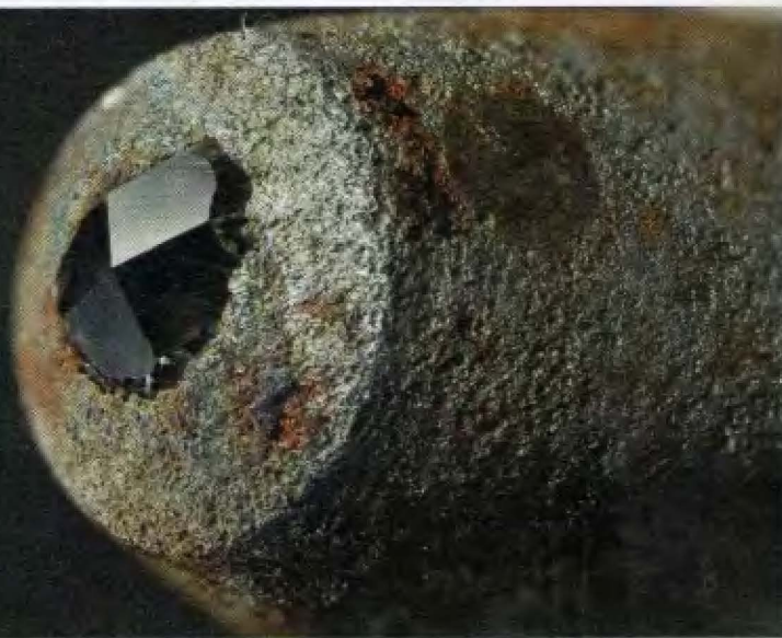
Вверху: алмаз в рабочей части инструмента. Слева: синтетические алмазы под микроскопом.
