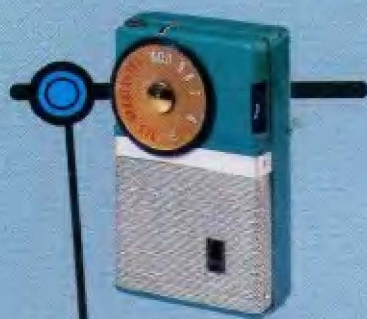
Радиоприемник «Sony TR-63», родоначальник «карманных» моделей.
