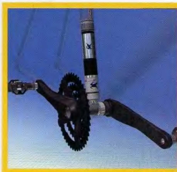
Микромотор, размещенный внутри рамы, помогал крутить педали нечестной спортсменке.
