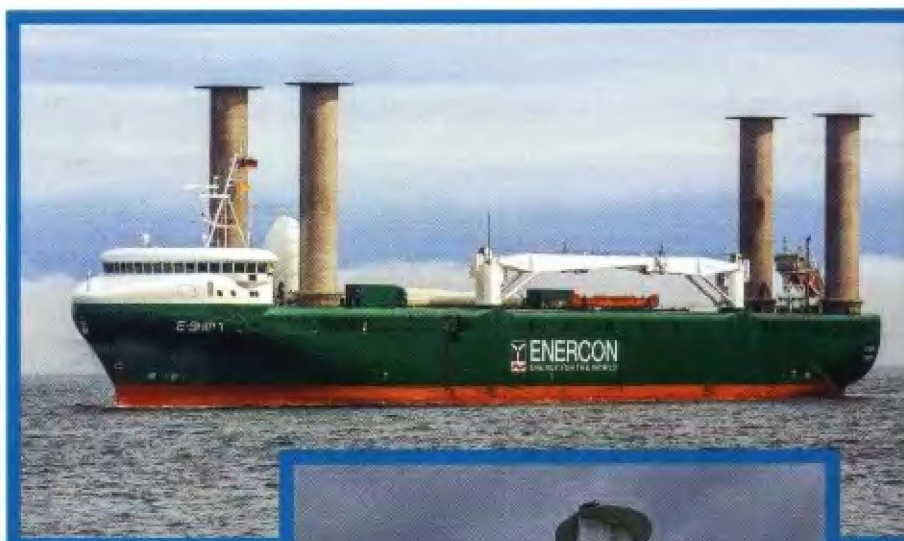
Сухогруз E-Ship 1, – самое крупное судно с роторным парусом.
