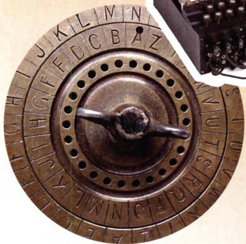
« Шифровальный диск – устройство, помогающее определить нужную букву в шифровании методом сдвига алфавита.
