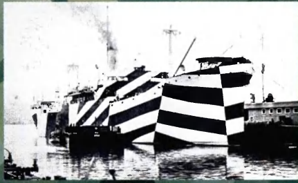
Корабль с ослепляющим камуфляжем, 1918 год. Трудно понять его форму и размеры!
