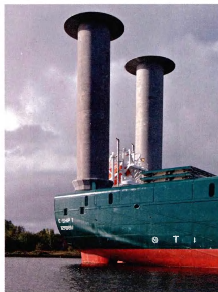
Корабль с роторными турбопарусами.
