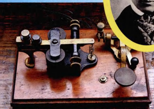
Устройство для создания «точек» и «тире» в телеграфе Морзе.
