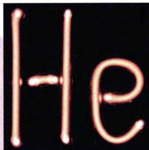
Светящаяся газоразрядная трубка с гелием в виде символа этого химического элемента
