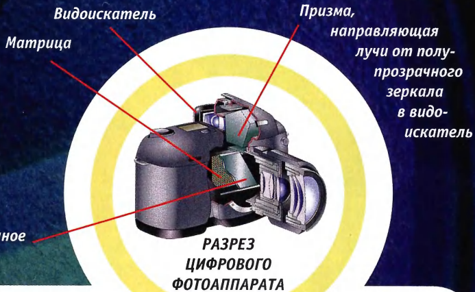
СХЕМА ЗЕРКАЛЬНОГО УСТРОЙСТВА ФОТОАППАРАТА 1. Объектив 2. Зеркало (полупрозрачное или откидное) 3. Светочувствительный слой 4. Светоотражающая призма 5. Окуляр видоискателя
