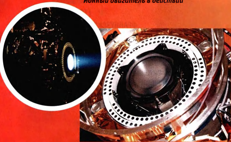
Ионный двигатель межпланетной космической станции «Дип Спейс – 1»
