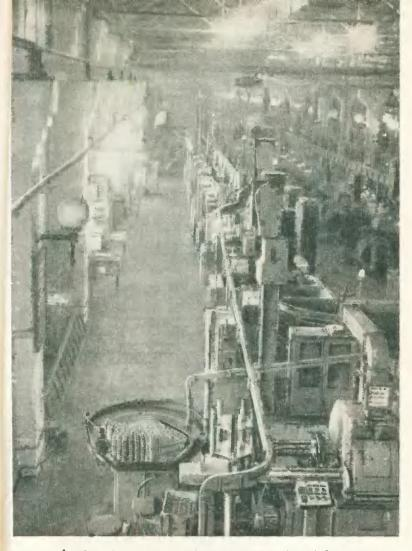
Автоматическая линия по производству шарикоподшипников.
